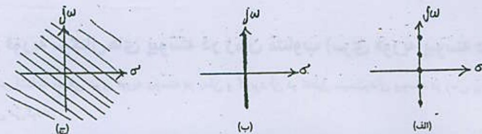
شکل ۷-۲. مکان s ها در صفحه مختلط (الف) سری فوریه (ب) تبدیل فوریه (ج) تبدیل لاپلاس
