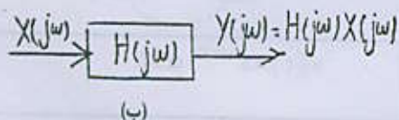
شکل ۹-۴ - (الف) رابطه ورودی - خروجی یک سیستم LTI در حوزه زمان (ب) رابطه بین تبدیل فوری ورودی و خروجی
