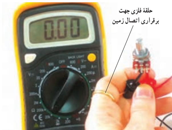
شکل ۳-۸- اتصال مقاومت متغیر به مولتی‌متر دیجیتالی
