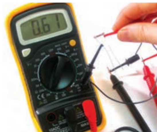
شکل ۳-۲۲ اندازه گیری مقاومت LDR
