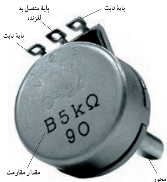
شکل ۳-۳ مقدار نوشته شده روی مقاومت
