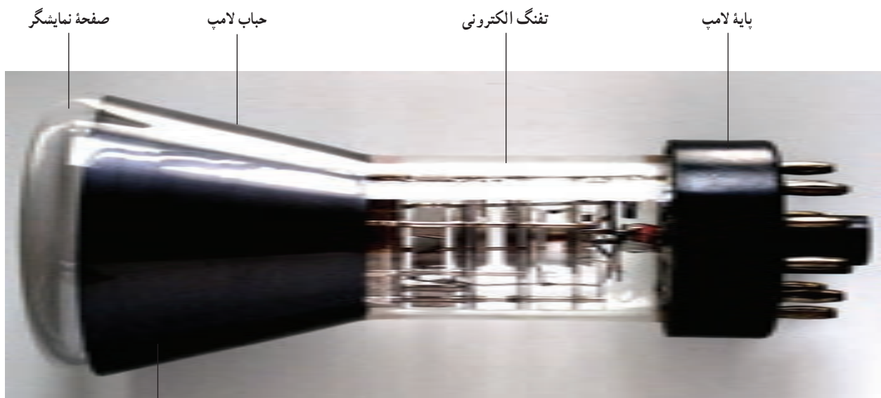
در حباب لامپ آند شتاب‌دهنده و صفحات انحراف قرار دارند
