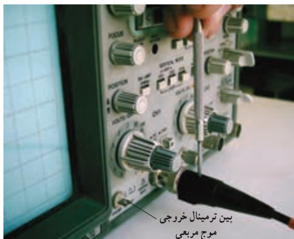
شکل ۵-۲۱- ترمینال خروجی موج مربعی
