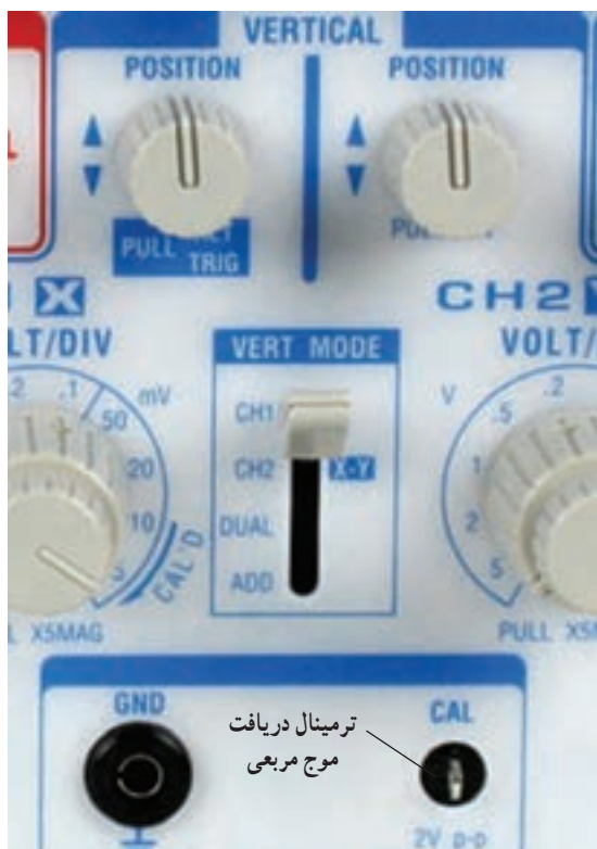
شکل ۱۸-۵- قسمت‌های مشترک و سایر تنظیم‌کننده‌های قسمت عمودی
