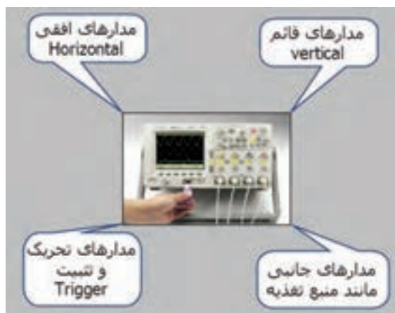
شکل ۵-۷ مدارهای داخلی اسیلوسکوپ
