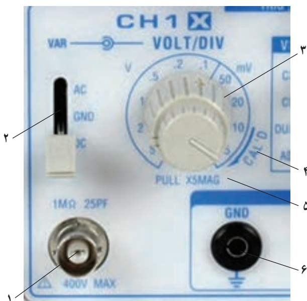
شکل ۱۴-۵ سلکتورها، ولوم‌ها و ترمینال‌های ورودی اسیلوسکوپ
