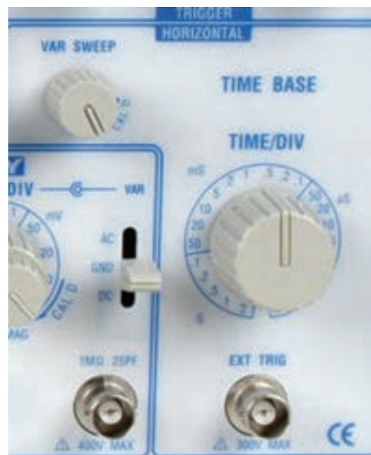
شکل ۱۹-۵ قسمت افقی اسیلوسکوپ
