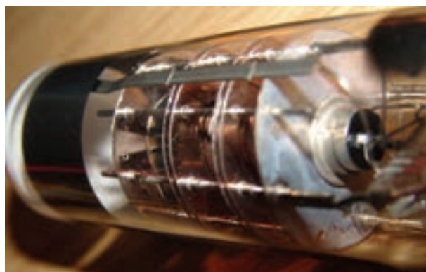
شکل ۴-۵ ساختمان داخلی تفنگ الکترونی
