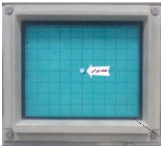
شکل ۵-۵ تولید نقطه نورانی به وسیله اشعه کاتدیک
