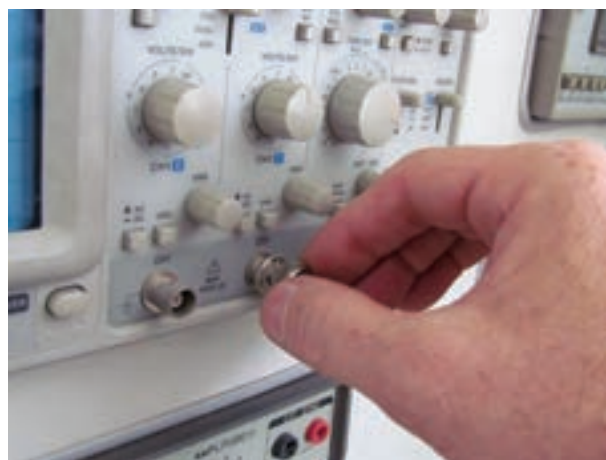
شکل ۵-۱۲ چگونگی اتصال BNC به اسیلوسکوپ
