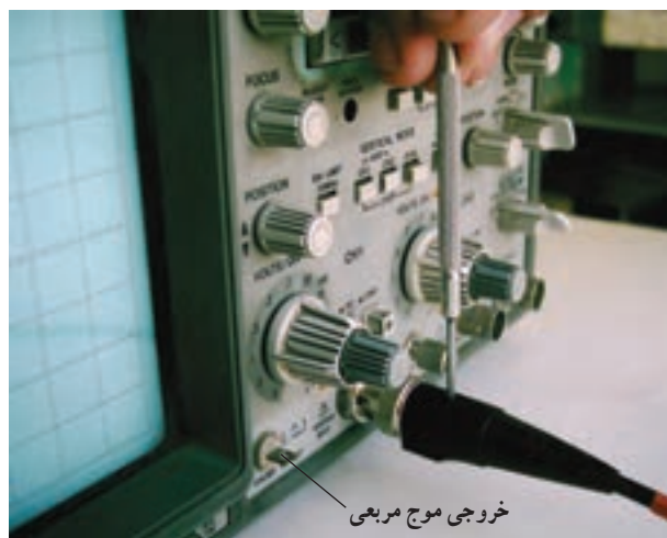
شکل ۵-۱۳ نحوه تنظیم پروب برای مشاهده موج مربعی
