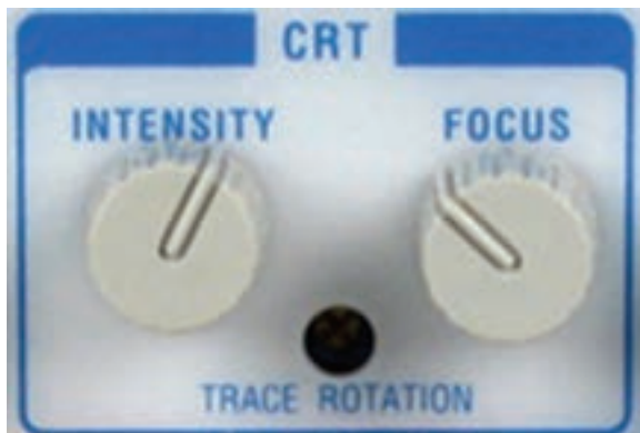
شکل ۵-۶ ولوم‌های تنظیم شدت نور و تمرکز اشعه
