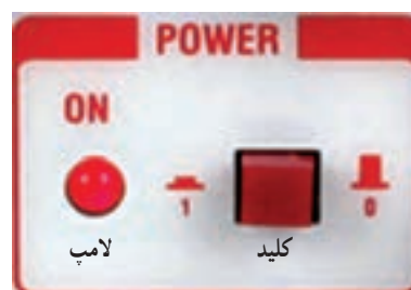
شکل ۵-۹ کلید خاموش و روشن اسیلوسکوپ
