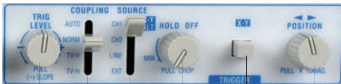
شکل ۱۹-۵ قسمت افقی اسیلوسکوپ
