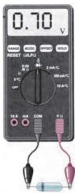
شکل ۷-۹- تعیین پایه ها و جنس دیود با استفاده از مولتی متر دیجیتالی
