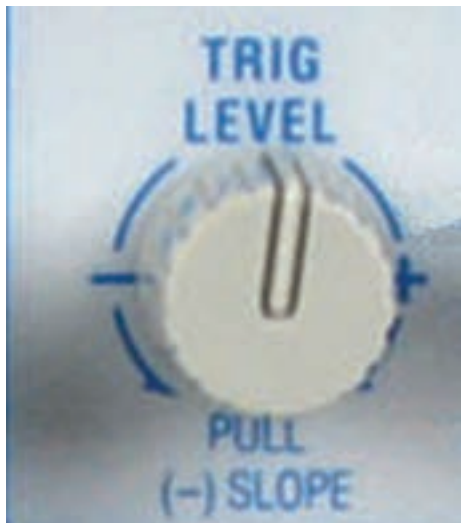
شکل ۱-۶- ولوم Level و Slope
