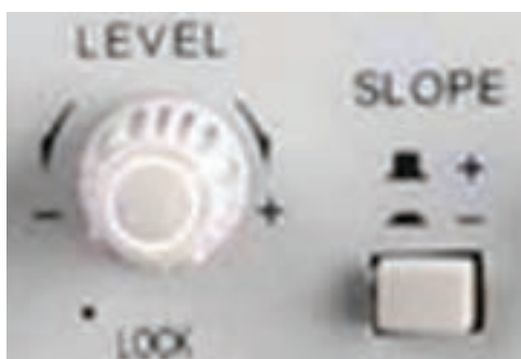
شکل ۳-۶- نمونه دیگری از ولوم Level و کلید Slope
