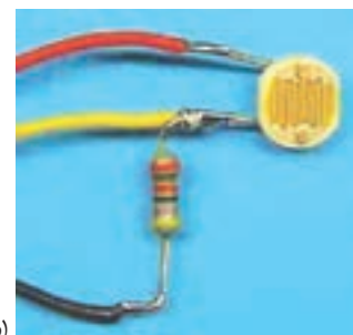
شکل ۱-۶۰ شکل ظاهری و نماد فنی مقاومت تابع نور LDR
