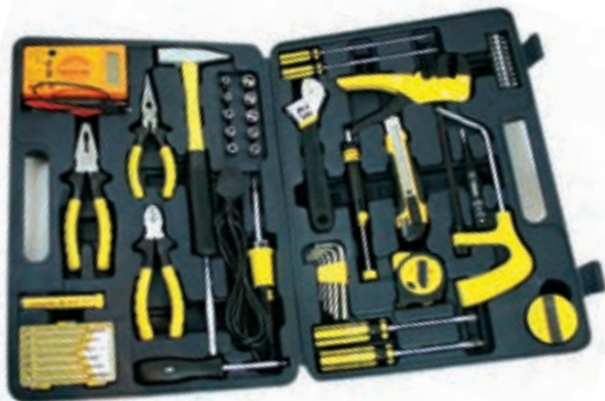
شکل ۱-۴-۱-۴ استفاده از ابزار با دسته عایق
